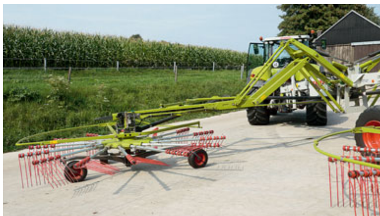
Das etwas „krakenartige“ Aussehen des Schwaders ist auch in der Konstruktion der Ausleger begründet. Die Konstruktion ist stabil, auch wenn es im ersten Moment etwas leicht gebaut erscheint.
