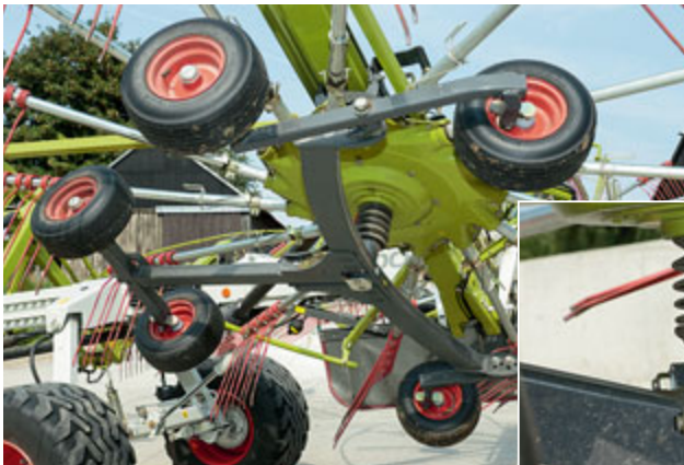
Die Fahrwerke der hinteren Kreisel haben sechs Räder, vorne sind es vier Räder. Die Skala der Rechhöhenverstellung ist vom Schlepper aus nicht zu sehen.
