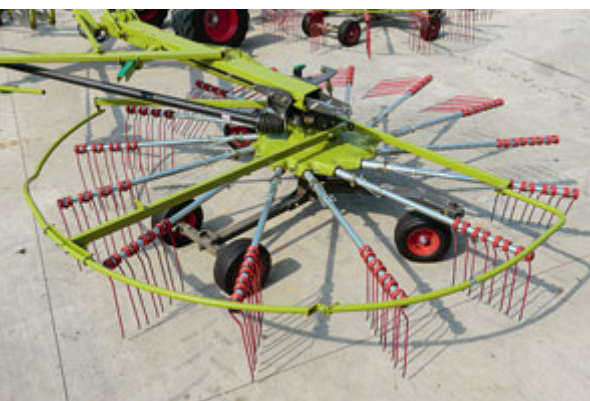
Die Kreisel haben 14 Zinkenarme und einen Durchmesser von 3,80 m. Die Arme werden auf den verzahnten und markierten Stummel aufgesetzt und mit dem Bügel der Profix-Zinkensicherung fixiert.
