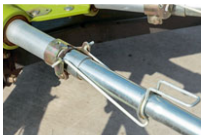
Die Kreisel haben 14 Zinkenarme und einen Durchmesser von 3,80 m. Die Arme werden auf den verzahnten und markierten Stummel aufgesetzt und mit dem Bügel der Profix-Zinkensicherung fixiert.
