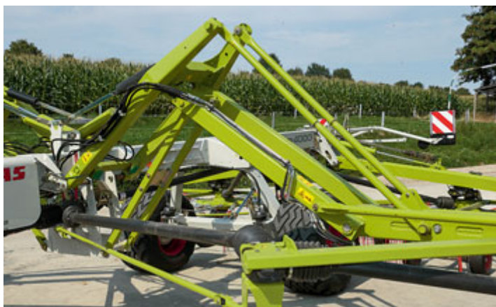
Das etwas „krakenartige“ Aussehen des Schwaders ist auch in der Konstruktion der Ausleger begründet. Die Konstruktion ist stabil, auch wenn es im ersten Moment etwas leicht gebaut erscheint.
