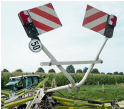
Die Beleuchtungsträger lassen sich manuell hochklappen. An Auffahrten, die durch Pfähle verengt werden, ist das manchmal hilfreich.
