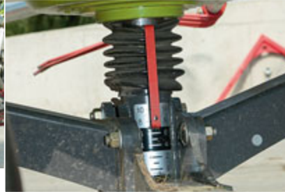
Die Fahrwerke der hinteren Kreisel haben sechs Räder, vorne sind es vier Räder. Die Skala der Rechhöhenverstellung ist vom Schlepper aus nicht zu sehen.
